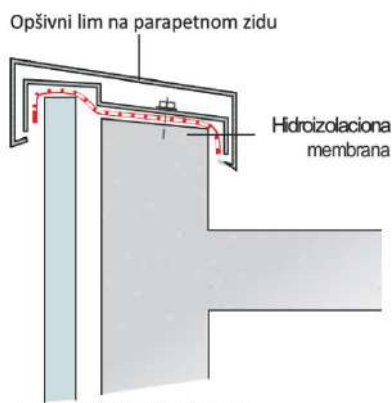
Slika 4.3.3-1 Pričvršćivanje hidroizolacione membrane
